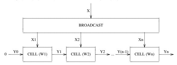
La  $k^{\text{ième}}$  cellule a pour poids  $w_k$ ; elle possède deux portes d'entrée X\_IN et Y\_IN et une porte de sortie Y\_OUT. En comportement permanent, elle lit une valeur x sur X\_IN puis une valeur y sur Y\_IN et émet  $y+w_kx$  sur Y\_OUT. En comportement transitoire elle lit (sans les traiter) (k-1) valeurs sur la porte X\_IN.
